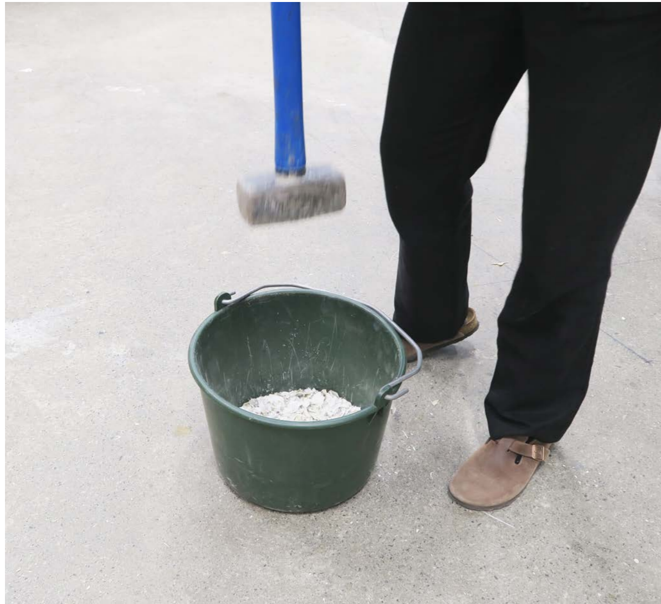
Knusing av østers i prosessen med å lage materialprøver.
